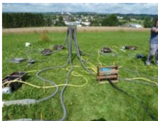
photo 8: mesures des pertes ammoniacales par volatilisation
